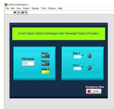
Gambar 5. Tampilan HMI Sistem Pendingin Ruang dan Status Produksi pada Industri Minuman Ringan
